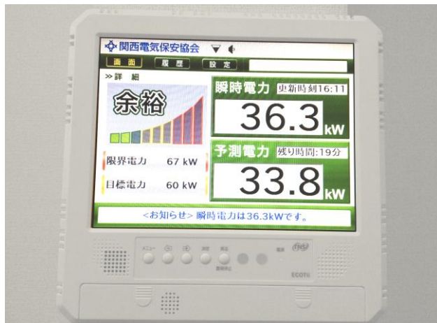
デマンド監視装置
