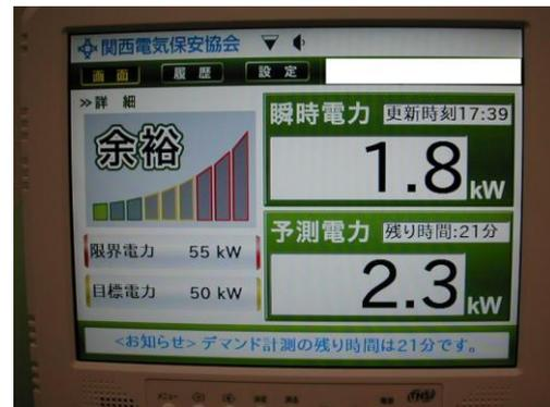
デマンド監視装置による電気使用量監視
