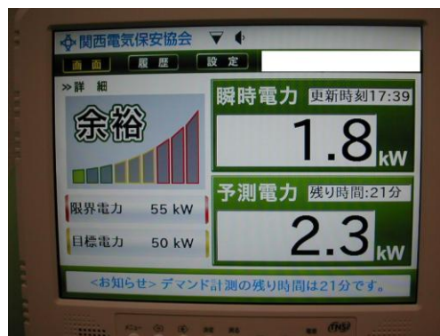
デマンド監視装置による電気使用量監視 (目標電力を 50kw から 45kw に下げました)
